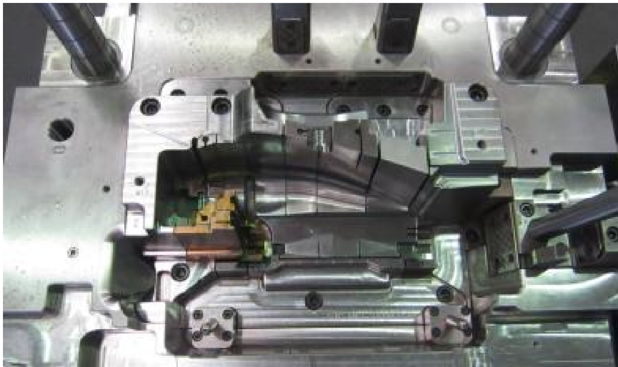
Prototyp matrycy wtryskowej z tworzywa sztucznego do drukarki wielokomponentowej
